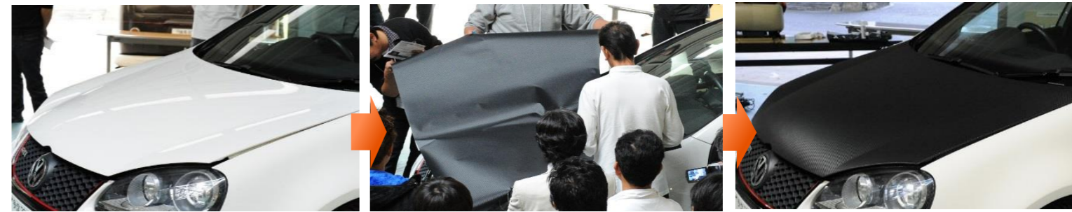
カーボン調フィルム施工例
